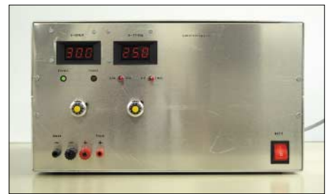
Bild 3: Frontansicht des 25-A-Netzteils mit Anzeigen und Sollwertpotenziometern
