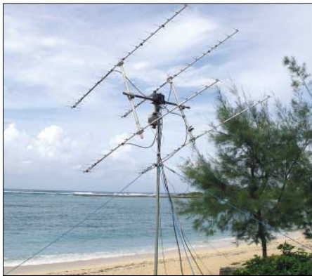
Mit 4 × 19-Ele.-Yagis gelangen einige EME-QSOs in CW auf 70 cm
