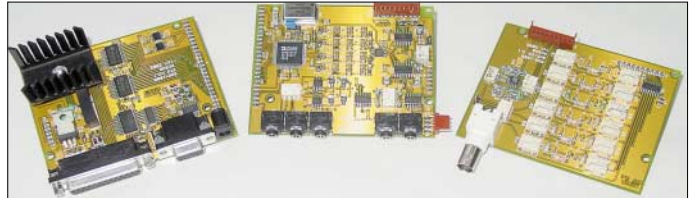
Bild 17: Die drei Platinen des SDR-1000: links – Speisung und Steuerung; Mitte – DDS-Oszillator und Mischer; rechts – Oktavfilter und Senderendstufe
