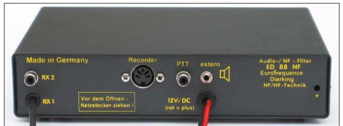
Bild 2: Die Kabel an der Rückfront für Stromversorgung und NF-Eingang ersparen separate Verbindungsleitungen.
